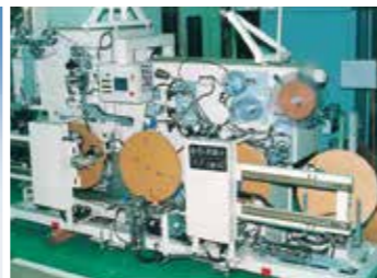
多列取りターミナルの反転巻取装置
